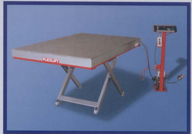
Baureihe FCE mit integrierter Waage und einer Bauhöhe von 120 mm bei 1200 kg Traglast
